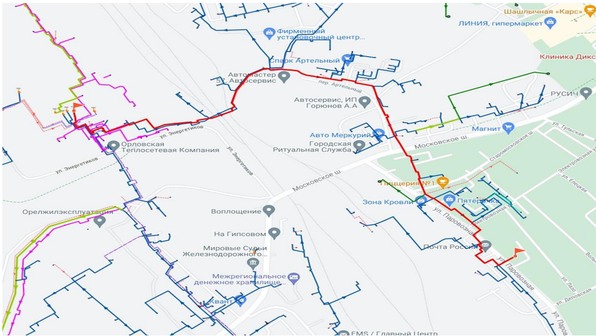
Рисунок 4.2.1 – Путь пьезометрического графика для участка теплосети ТМ-3 от «Орловская ТЭС» до перспективной застройки общеобразовательная школа
