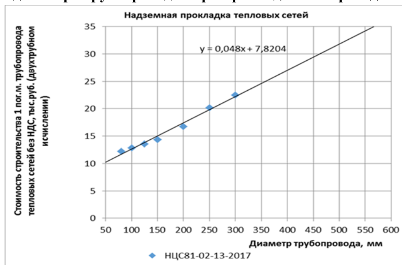
Рисунок 12.1.3 – Зависимость стоимости строительства трубопроводов тепловых сетей от диаметра трубопроводов при надземной прокладке на низких опорах
