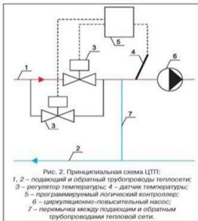
Рисунок 1.3.5.6 – Принципиальная схема ЦТП
