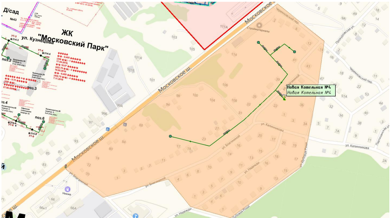
Рисунок 8 - Зона действия новой котельной № 4
