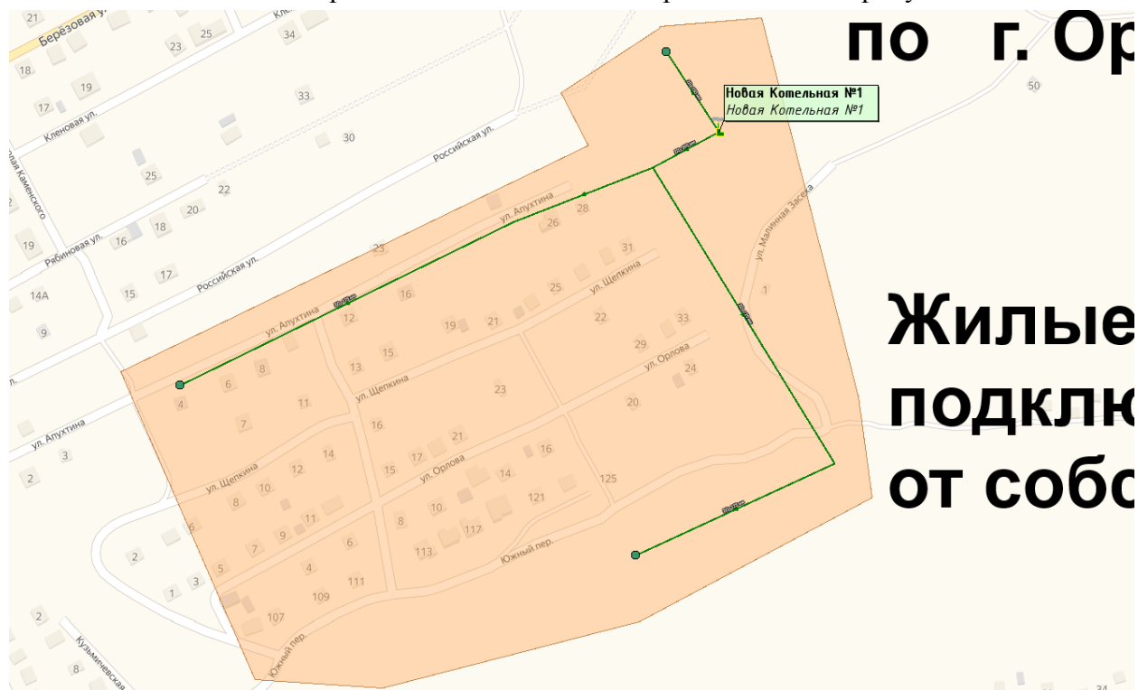
Рисунок 5. – Зона действия новой котельной № 1
